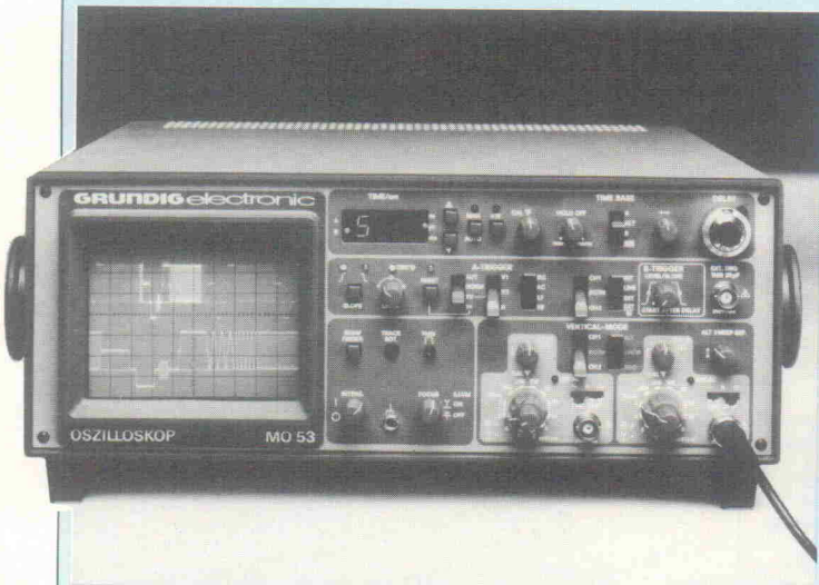
Das Digitaldisplay kennzeichnet die Besonderheit von Grundig's MO 53: die Zeitbereichsautomatik. Eine spürbare Entlastung für denjenigen, der oft viele unterschiedliche Signale messen muß (Foto: Grundig).
