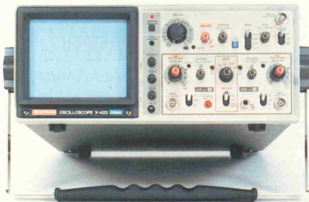
Über eine spezielle Meßbuchse läßt sich an Hitachi's V-422 ein Multimeter anschließen; dadurch können Gleichspannungsanteile in Meßsignal und andere Größen bequem ausgelesen werden (Foto: Kontron).
